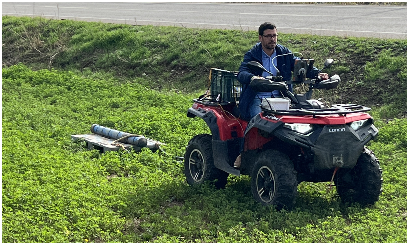
Imagen 6. Demostración del mapeo de la conductividad eléctrica aparente del suelo con el sensor Dual.
